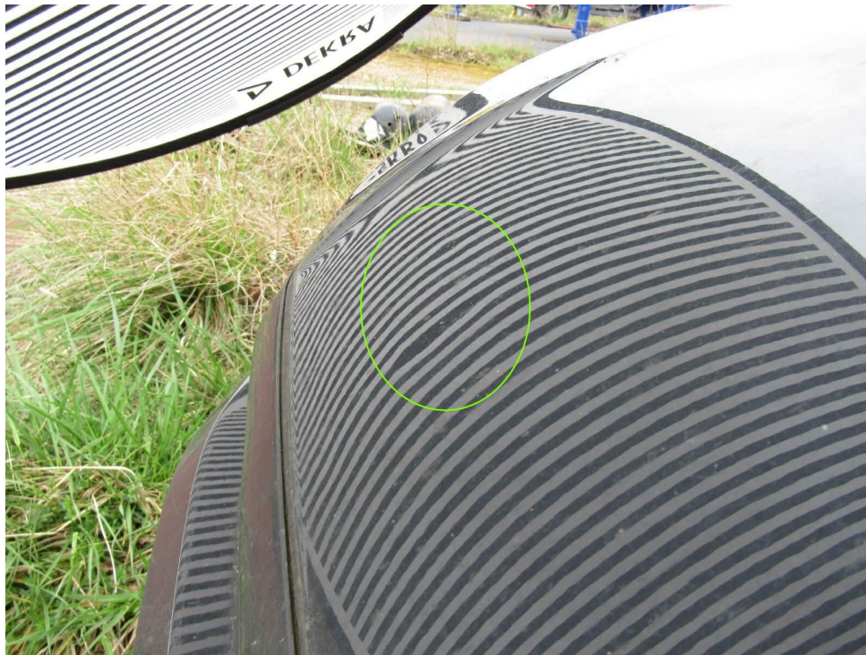
Bild 7 : Motordeckel mehrfach eingedellt
