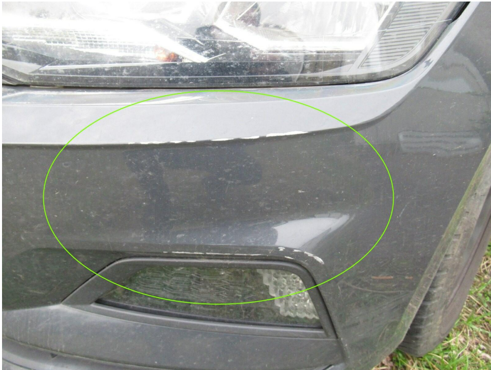
Bild 9 : Stoßfänger linksseitig verschrammt
