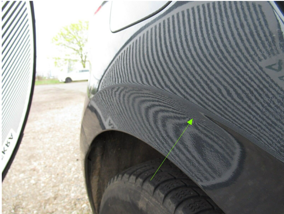
Bild 13 : Radlauf rechts eingedellt
