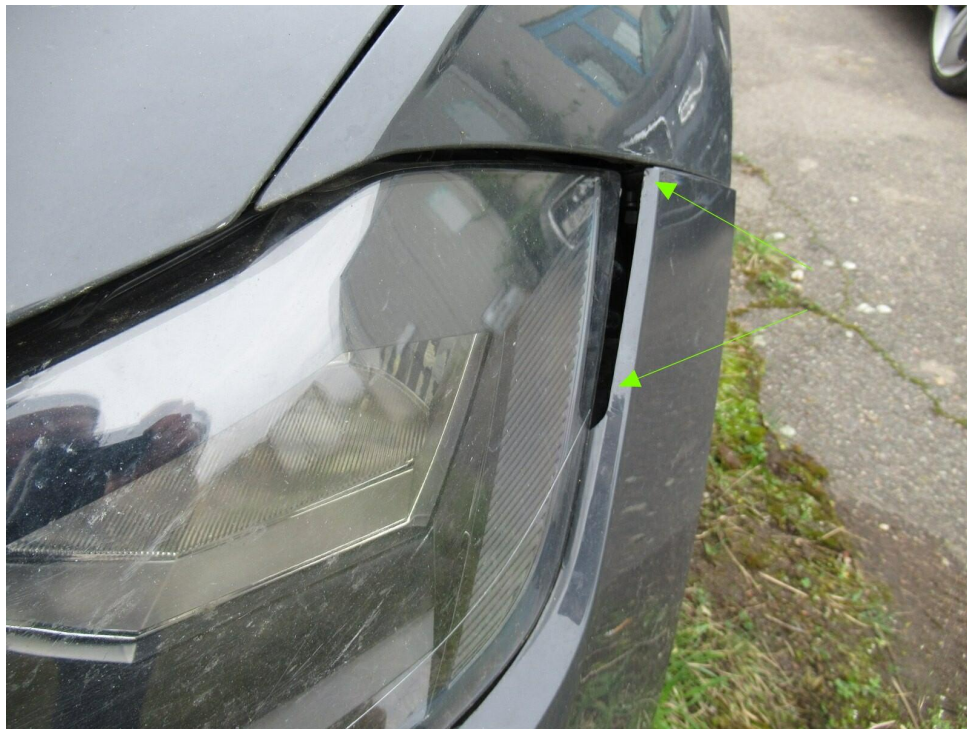
Bild 8 : Stoßfänger vorne linksseitig steht ab
