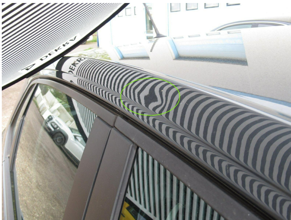
Bild 12 : Dachholm rechts eingedellt
